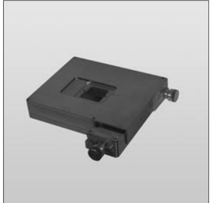
Die Kreuztische der Serie PKT zeichnen sich durch eine niedrige Bauhöhe aus. Hauptsächlich für optische Anwendungen besitzt der Kreuztisch eine quadratische Apertur. Für Anwendungen, bei denen die Apertur nicht benötigt wird, steht eine Einsatzplatte mit Montagebohrungen zur Verfügung. Die weit auseinanderliegenden Führungen lassen ein hohes Kippmoment sowohl in x- als auch in y-Richtung zu.
