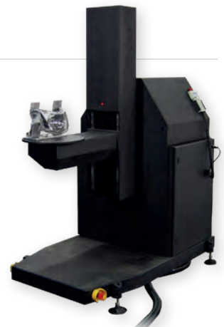
> Exemple de goniomètre automobile en champ lointain
