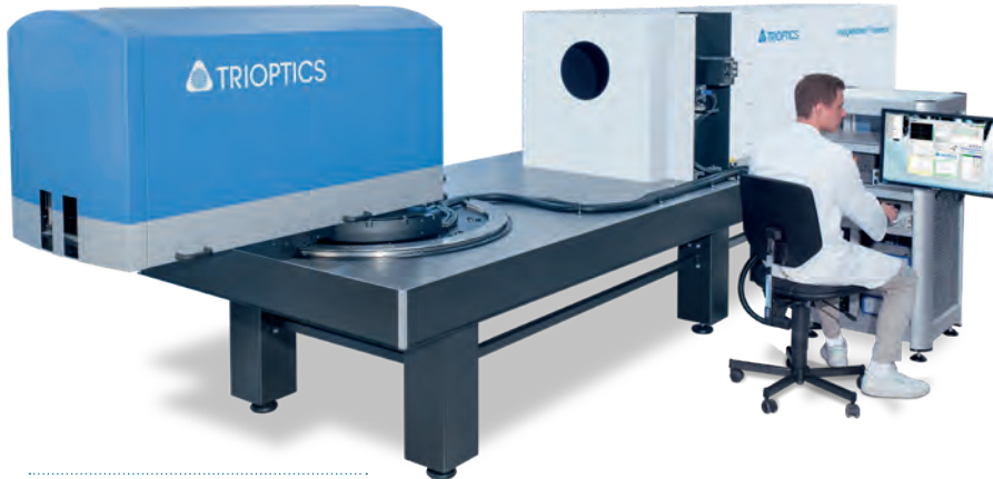
> Station de mesure de la FTM ImageMaster Universal
