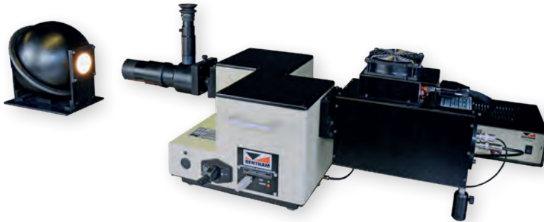
> Exemple de banc conçu sur cahier des charges: test jumelles vision nocturne
