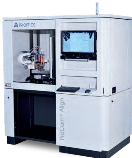
> Assemblage automatisé de modules caméra
