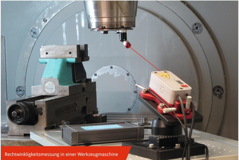
Rechtwinkligkeitsmessung in einer Werkzeugmaschine
