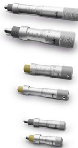
Die OWIS® Messschrauben MS haben gehärtete und präzise geschliffene Spindeln. Messtrommel und Messhülse sind matt verchromt und bieten daher größtmöglichen Kontrast zu den Skalenstrichen. Als Druckstück ist eine gehärtete Stahlkugel in die Spindel eingelassen. Damit eignen sich diese Messschrauben vor allem als hochpräzise Stellantriebe.
