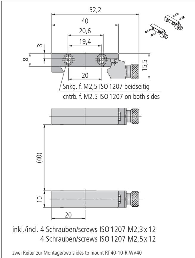
**Technische Daten/Technical Data KSHM 40** (bei 20 °C/@20 °C, ohne Last/no load)
