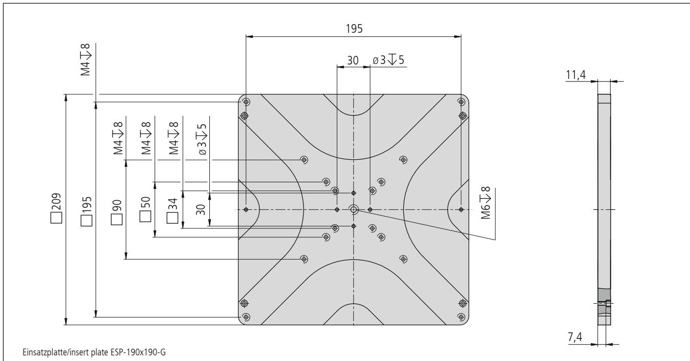
Einsatzplatte/insert plate ESP-190x190-G
