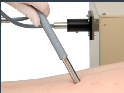
La méthode HDRS (Spectroscopie de Réflectance Diffuse Hybride) combine les valeurs d'absorbance in-vivo et in-vitro pour obtenir une mesure complète sur la plage spectrale 290-400nm.
