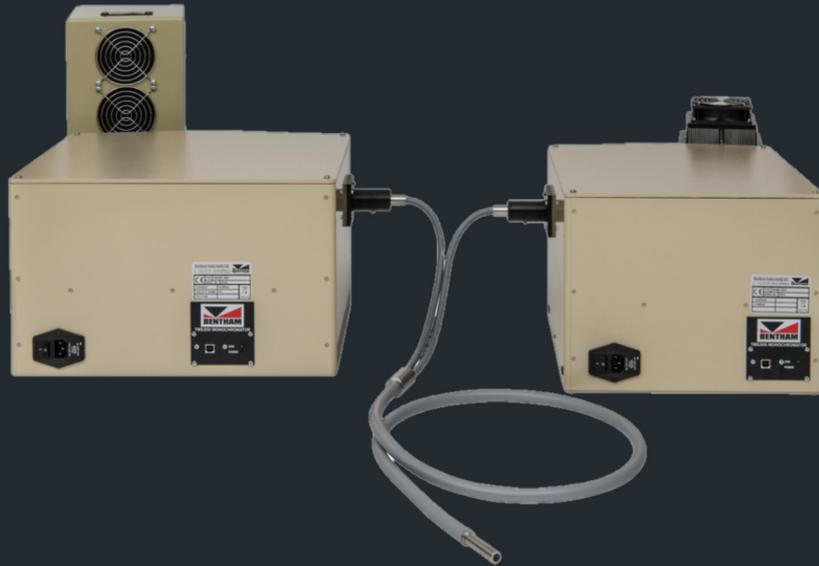
Le HDRS300 (Hybrid Diffuse Remission Spectroscope) permet la caractérisation de l'absorbance in-vivo des crèmes solaires sur la gamme 290-400nm avec un pas de 1nm.
