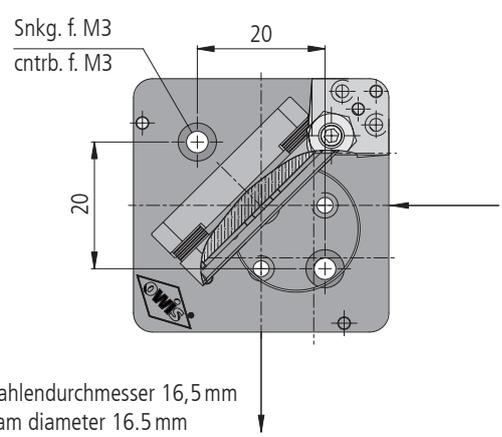
KSH 40-D26-LI-T, Ablenkung nach links (KSH 40-D26-RE-T spiegelverkehrt)/deflection to the left (KSH 40-D26-RE-T mirrored)
