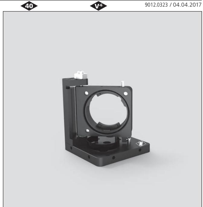
Die Klappspiegelhalter KSH 40 können in allen Einbaulagen eingesetzt werden. Die Optiken werden mit einer Schwenkplatte im  $45^\circ$  in den Strahl geklappt. Damit können Lichtstrahlen um  $90^\circ$  umgelenkt werden. Der Wiederholfehler ist kleiner als  $100 \mu\text{rad}$ .
