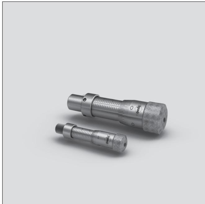
Die OWIS® Messschrauben MS 10 haben gehärtete und präzise geschliffene Spindeln. Messstrommel und Messhülse sind matt verchromt und bieten daher größtmöglichen Kontrast zu den Skalenstrichen. Als Druckstück ist eine gehärtete Stahlkugel in die Spindel eingelassen. Damit eignen sich diese Messschrauben vor allem als hochpräzise Stellantriebe.
