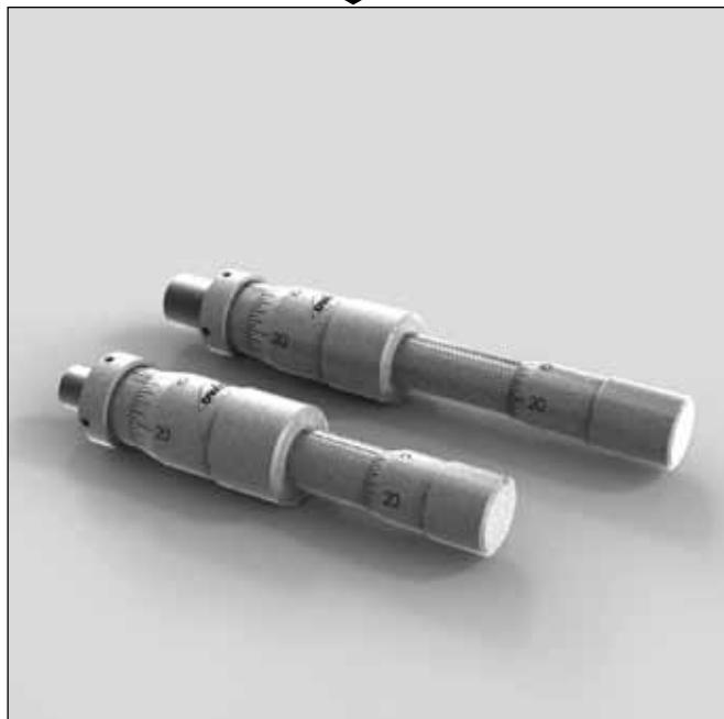
Die OWIS® Differential-Messschrauben MSD haben gehärtete und präzise geschliffene Spindeln. Die Skalenwerte von 0,5 µm gestatten kleinste Positionsänderungen. Messtrommel und Messhülse sind matt verchromt und bieten daher größtmöglichen Kontrast zu den Skalenstrichen. Als Druckstück ist eine gehärtete Stahlkugel in die Spindel eingelassen. Damit eignen sich diese Messschrauben vor allem als hochpräzise Stellantriebe.
