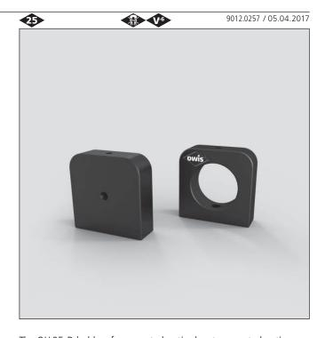
Gefasste Optiken, Einsätze und Justiereinsätze werden mit Hilfe der Halter für gefasste Optiken OH 25-D im Strahlengang fixiert. Für die Montage auf Reitern RT 25 haben alle OH 25-D Gewindebohrungen M2,5. Zusätzlich verfügen alle Halter über eine M4-Bohrung für die Montage auf Stiften.
