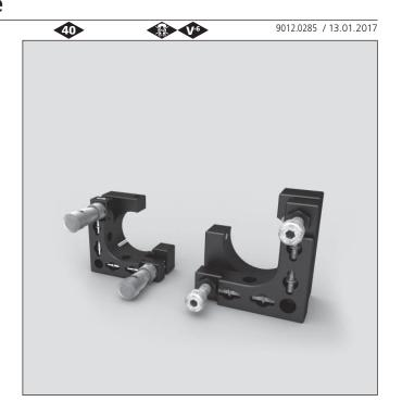
Die Transjustierungen mit offener Ecke TRANS 40C werden vorzugsweise für transmittierende und strahlteilende Optiken eingesetzt. Es können wahlweise gefasste Optiken mit Durchmesser 25 mm oder ungefasste mit Durchmesser 25,4 mm (1") in den Strahlengang eingebaut werden.
