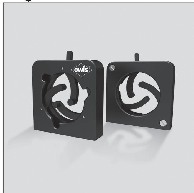
Die Universaloptikhalter UNOH 40 sind für Optiken mit Durchmessern von 9 mm bis 25,4 mm geeignet. Sie sind flexibel auf Reiter RT 40 in SYS 40 oder auf Stifte montierbar.
